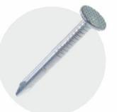
**2.3.2** Для механической фиксации гибкой черепицы к основанию применяют оцинкованные кровельные гвозди с увеличенной шляпкой диаметром не менее 8 мм. Расход гвоздей 70–100 г/м<sup>2</sup>
