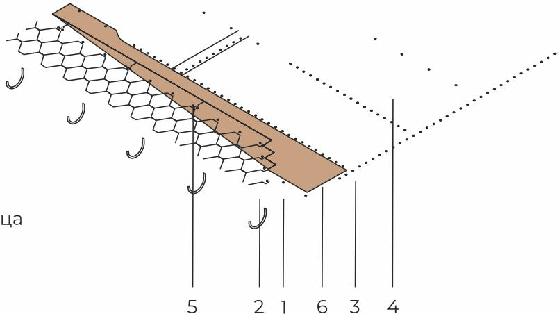
**5.3.2** При отсутствии карнизной черепицы можно применить рядовую кровельную черепицу, которую в этом случае укладывают вырезами вверх таким образом, чтобы кровельная черепица не доходила до края карнизной планки (капельника) на 10–50 мм.
